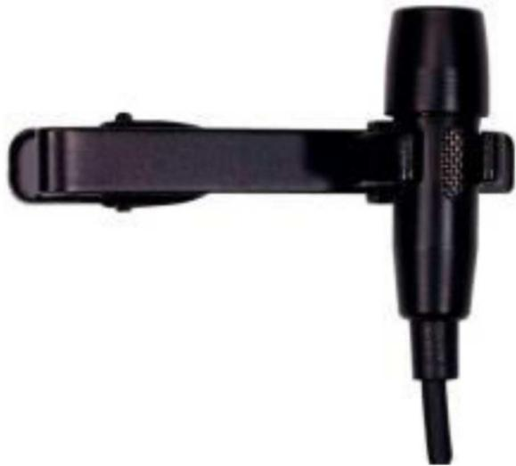
Das **Ansteckmikrofon** wird mit einer Klemme oder einer Anstecknadel am Revers oder an der Krawatte befestigt. Von diesem Mikrofon führt ein dünnes Kabel zum Taschensender, an dem wiederum eine Sendeantenne befestigt ist.
